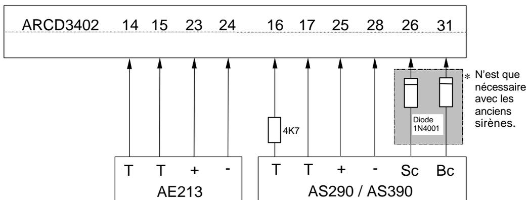
Figure 14. Câblage du AS290/390 + sirène intérieure
