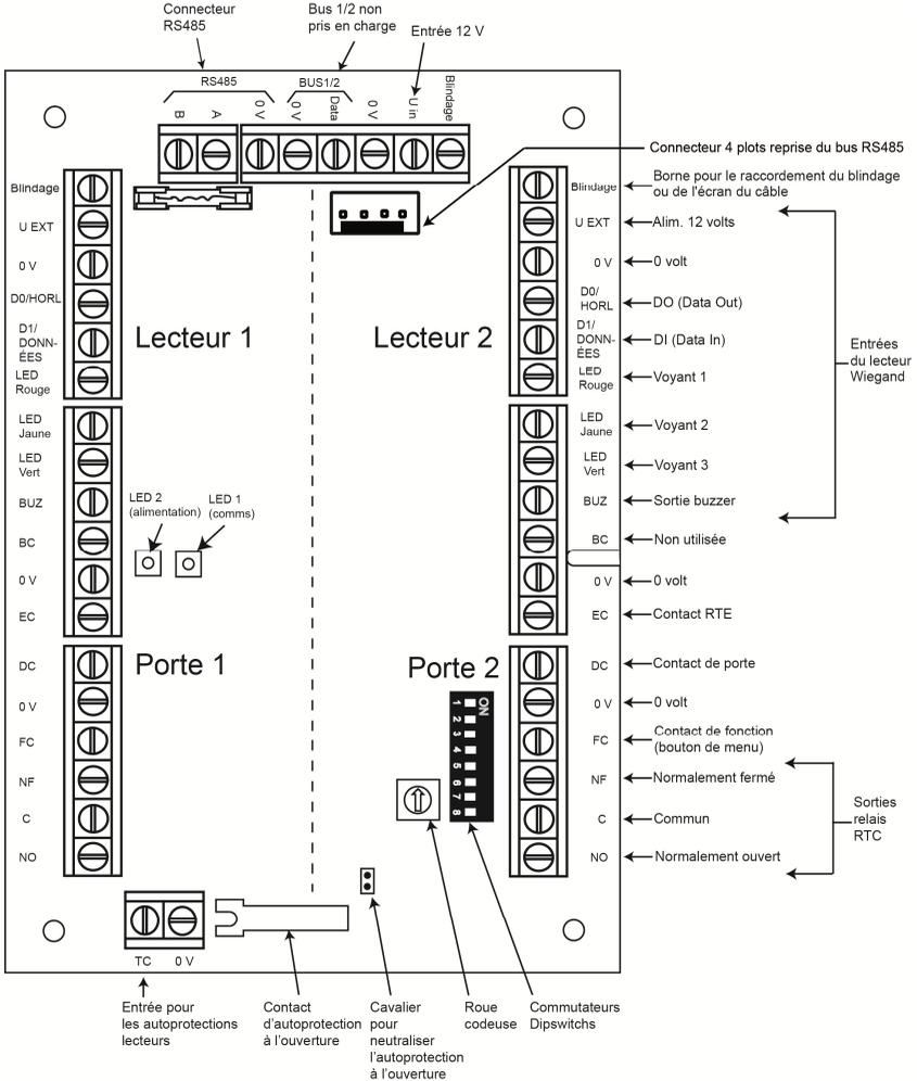
Figure 17 Carte électronique du module de contrôle d'accès
