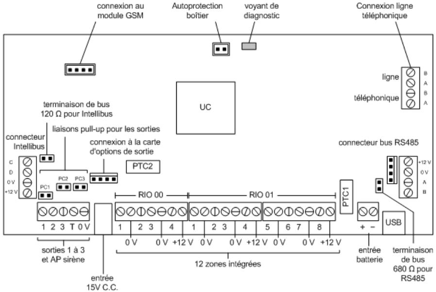
Figure 3 Topologie et connectique de la carte principale
