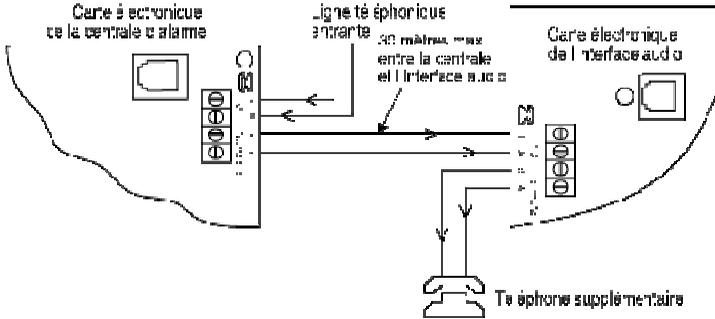
Figure 16 Interface audio connecté à la ligne RTC
