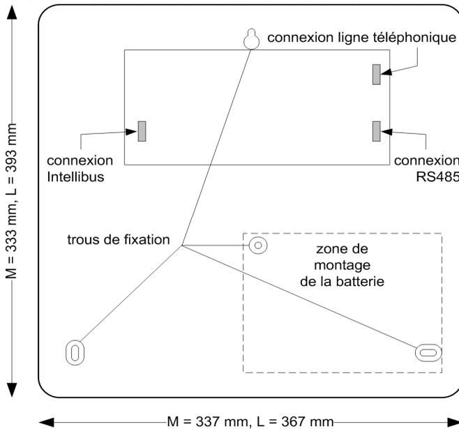
1. Fixez la centrale au mur à l'aide des trous de fixation illustrés. Vérifiez que le couvercle peut être suffisamment ouvert pour être retiré ou pour vous permettre d'accéder à la centrale pour la câbler.
