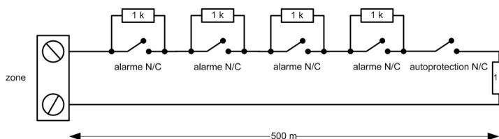
**Figure 6 Câblage d'une zone vers plusieurs détecteurs**
