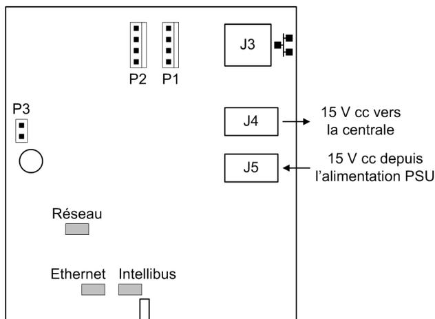
4. Dans le boîtier de la centrale d'alarme, installez le module Ethernet dans le rack de module le plus proche de la carte principale de la centrale.
