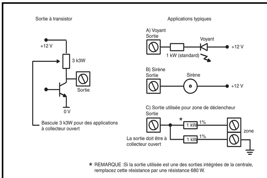
Figure 2-15. Configuration de sortie et applications standard
