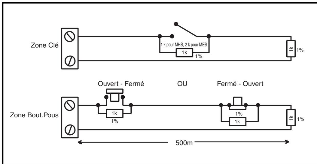
Figure 2-14. Câblage du terminateur à la zone Clé
