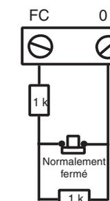
Raccordement du contact de fonction
