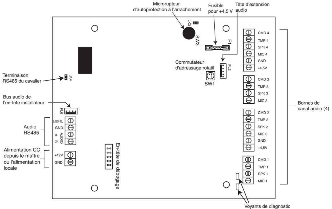
Figure 3-8. Carte électronique du module MUX
