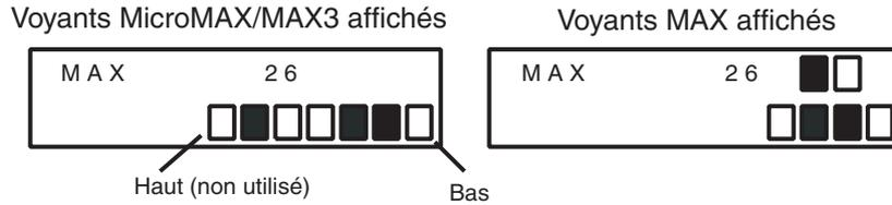
Le n° du bus est représenté sur la ligne supérieure pour le lecteur MAX et les carrés 2 et 3 pour les lecteurs MicroMAX. L'adresse est représentée sur la ligne inférieure des blocs pour le lecteur MAX et par les quatre derniers carrés inférieurs pour le lecteur MicroMAX. Dans ce mode, le voyant supérieur de MicroMAX est toujours éteint.
