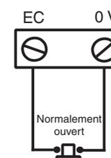
Raccordement du contact de requête de sortie
