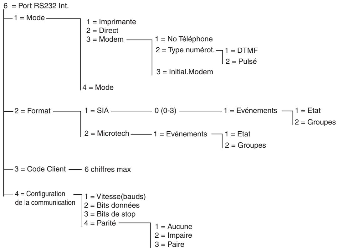
**Figure 6-10. Structure de programmation du module RS232 interne**
