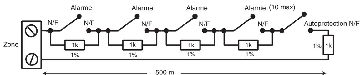
Figure 2-13. Câblage d'une zone vers plusieurs détecteurs
