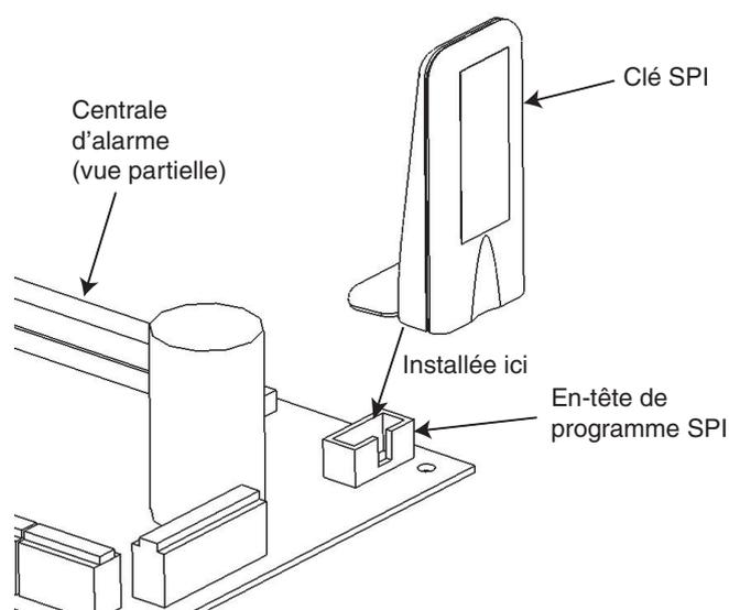
Figure 2-19. Connexion de la SPI KEY sur l'embase de programme
