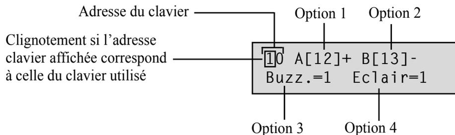
Sélectionnez le clavier souhaité en entrant l'adresse du clavier ou à l'aide des touches **A** et **B**, puis appuyez sur la touche **ent**. Le clavier affiche **1=TOUCHE >A**. Utilisez les touches **A** et **B** pour sélectionner l'option souhaitée et appuyez sur la touche **ent**.
