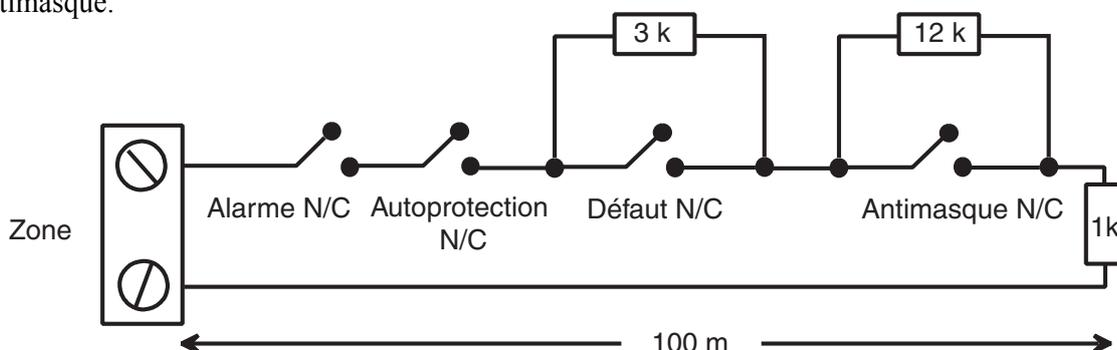
Figure 2-12. Option 10 - Câblage zone/détecteur de fin de ligne
