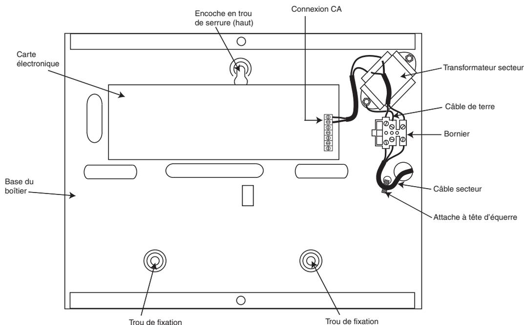
**Figure 2-4. Fixation du câble d'alimentation sur la base du boîtier**
