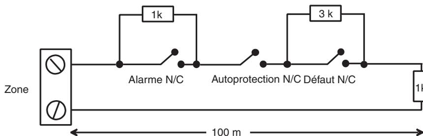
**Figure 2-10. Option 09 - Câblage de surveillance des défauts boucle équilibrée 1k**
