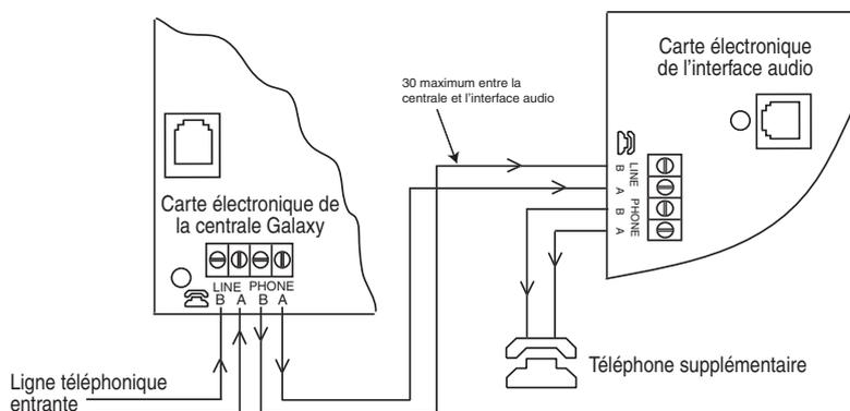
Figure 3-7. Interface audio connecté à la ligne RTC
