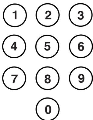
Les touches numériques servent à entrer le code PIN (Personal Identification Number = Numéro personnel d'identification), qui permet d'identifier les utilisateurs de la centrale Galaxy et de les autoriser à accéder aux options système. Le code PIN est un numéro à 4, 5 ou 6 chiffres (par défaut : 5 chiffres mini).
