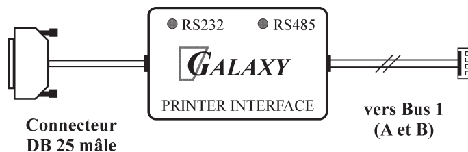
Figure 3-18. Le module Imprimante équipé du connecteur série de type DB25.
